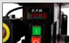
Digital display with speed indication. Pantalla digital con indicador de la velocidad de rotación.
