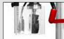
Chuck protected by microswitch. Protección del mandril con microinterruptor de seguridad.
