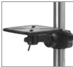
Tilting table up to 360° Mesa de trabajo inclinable a 360°
