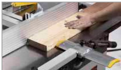
Aluminium parallel guide for upper table works Guía paralela de aluminio para los trabajos de mesa superior
