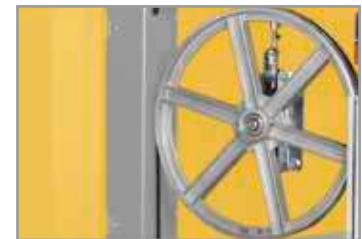
354 mm flywheels and blade tensioning device Volantes de diámetro 354 mm e indicador de tensión de la cinta
