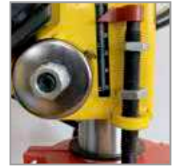
Graduated rod for drilling depth adjustment Varilla graduada para ajustar la profundidad de perforación
