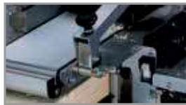
Thicknessing operation (l=154 mm - h 100 mm) Operación de regresado (l=154 mm - h=100 mm)
